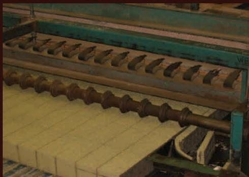
**5** ワイヤーにて組積用レンガの大きさに切断する。
