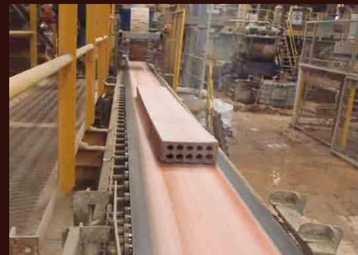
**4** 頁岩と粘土を混ぜ水と練り合わせた後、形成機により羊羹状に押し出す。
